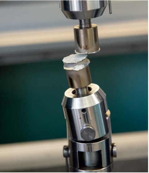
根据美国材料与试验协会 (ASTM) F 1147标准进行测试, 喷涂TiGrowth® 的样片测得的粘结强度示例。
