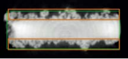
动物研究所采用样品的X射线图像。顶部和底部表面应用TiGrowth® 涂层。
