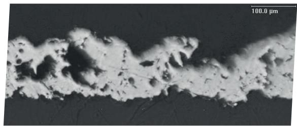
Spondycoat®-T 107是一种高粗糙度钛涂层(代表值Ra 20-40 µm)，推荐厚度为125-250 µm。
