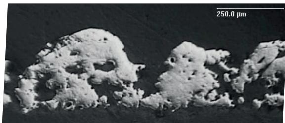
Ti-Growth®是一种高粗糙度多孔钛涂层(代表值Ra 40-80 µm)，推荐厚度为300-500 µm。
