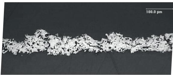
Spondycoat®-T 371A是一种低粗糙度钛涂层(代表值 Ra 4-10 µm)，主要用于标识薄层(推荐厚度60-120 µm)。
