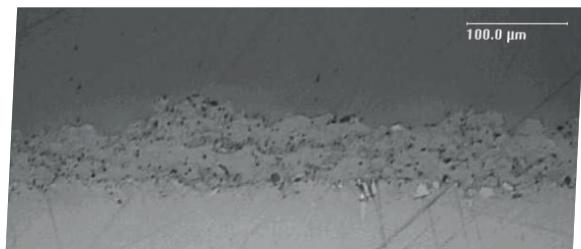
Spondycoat®-HA是一种低粗糙度羟基磷灰石涂层(代表值Ra 4-8 µm)，主要用于标识薄涂层(推荐厚度45-85 µm)。
